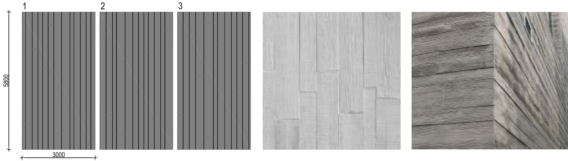
Naudojami trijų rūšių klojiniai plokščių apdailai
